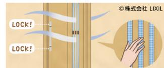
採風部分は網戸がついているので虫が気になる夏場も安心。ドアのカギを閉めたまま採風でき、採風部分は外から手を差し込めないデザインで防犯性にもしっかり配慮しています。
